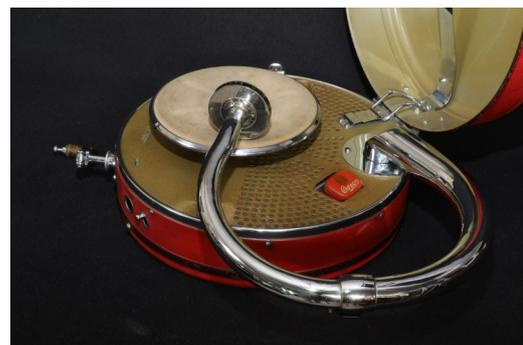
Le « **COLIBRI** » de construction belge avec son bras télescopique, ainsi que l'appareil français « **GIPSY** » avec son pavillon en carton pliable, se rapprochent de la grandeur du MIKIPHONE. Ces deux appareils comportaient également, comme bien de ces « cameraphones », un moteur et un diaphragme fabriqués à Sainte-Croix en Suisse, soit par PAILLARD, soit par THORENS.
