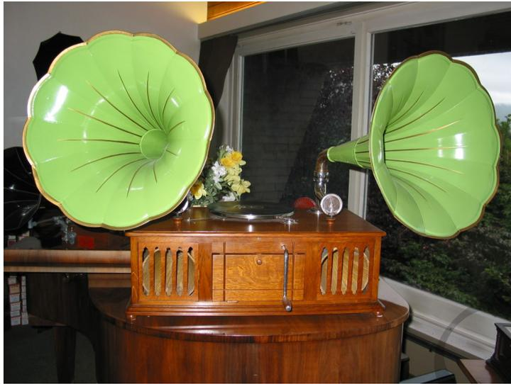
Le modèle « N°7 » de l' « **OLOPHONE** » était équipé de deux bras de lecture placés à gauche et à droite du plateau du disque. Les deux têtes de lecture devaient être placées dans le même sillon en face l'une de l'autre, à courte distance, provoquant un léger écho à l'écoute.
